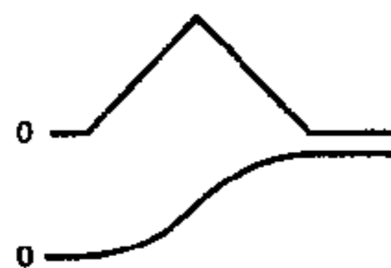
Рис. 8.19. Интегрирование треугольного импульса
