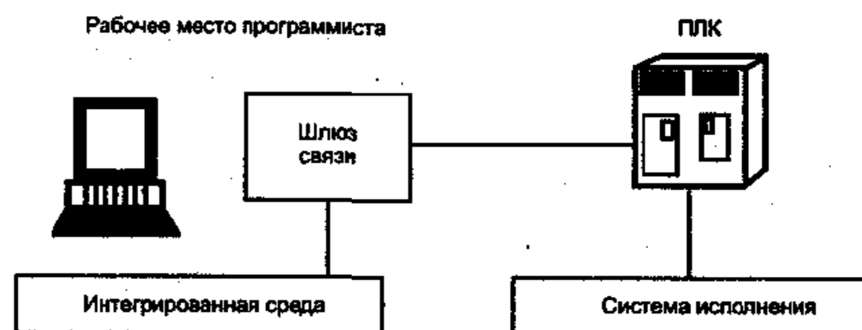
Рис. 3.10. Соединение интегрированной среды программирования с ПЛК
