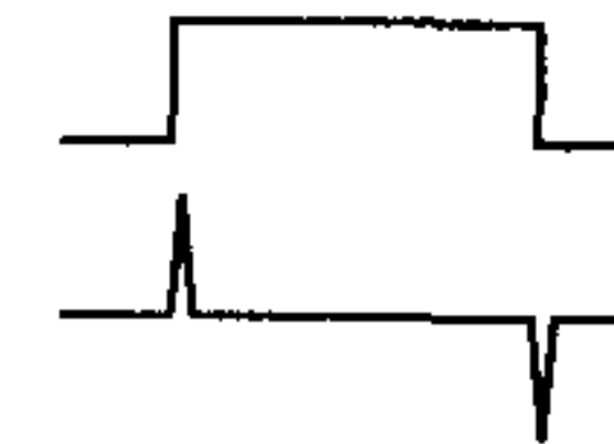
Рис. 8.16. Дифференцирование прямоугольного импульса
